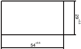
Q48-JS-1 计时器开孔尺寸图：
